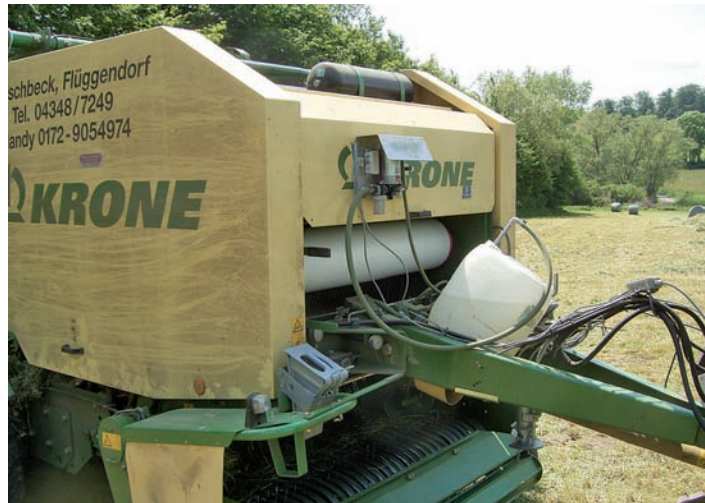
Flüssigapplikation von Silierzusätzen an Pressen: Bei MSB-Einsatz 2 L/t FM einsetzen.
