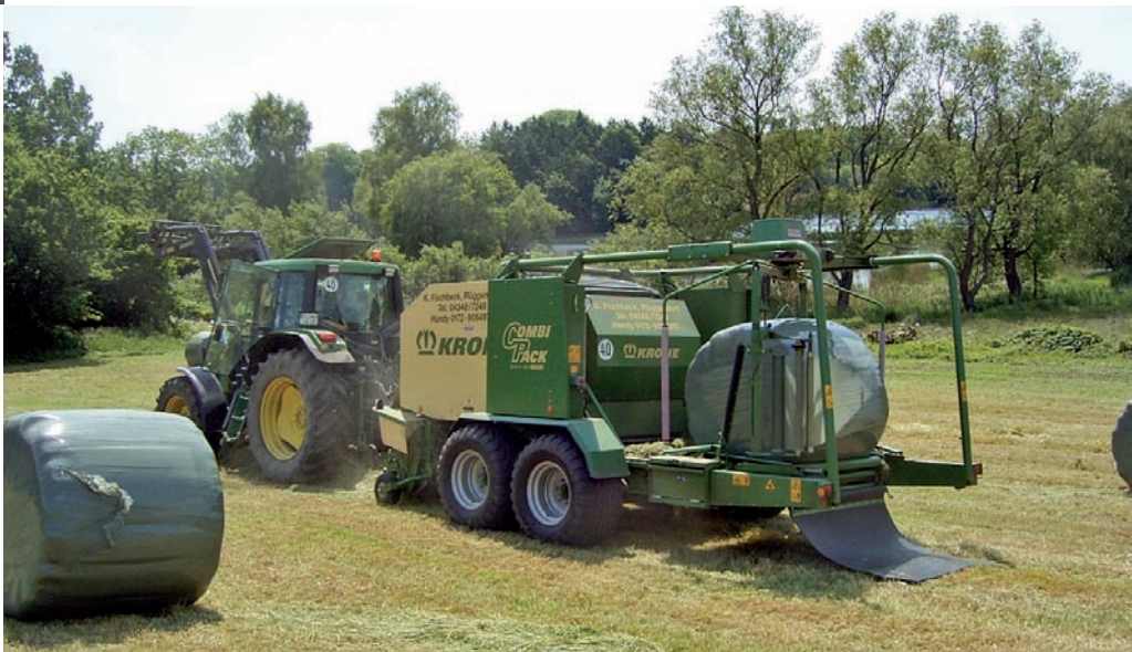
Pressen und wickeln in einem Arbeitsgang bringt sofortige Silierung, bessere Qualität und niedrigere Kosten. Wichtig ist ein optimal geschärftes und ausgerüstetes Schneidwerk der Presse. Durch gut arbeitende Schneidwerke lassen sich 15 bis 20 % mehr Masse in den Ballen bekommen.
