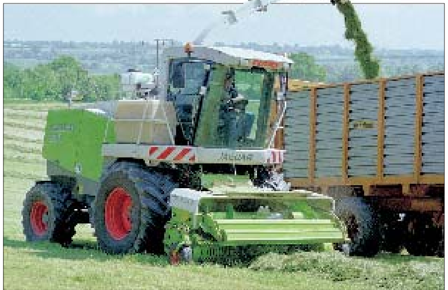
Siliermitteldosierung (neben der Kabine) aufgrund der gemessenen Erträge und der ermittelten TM-Gehalte direkt in den Auswurf-Beschleuniger an einem Exakthäcksler.
