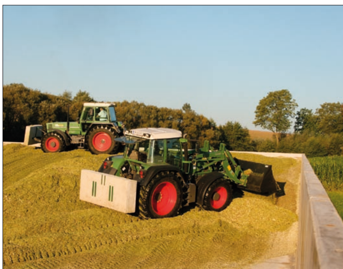
Selbst bei größter Sorgfalt lassen sich die Randbereiche im Silostapel oft nur unzureichend verdichten (links). Hier kann – ähnlich wie an Anschnittflächen (oben) – einem Verderb mit geeigneten Additiven und einer speziellen Dosiertechnik entgegengewirkt werden.
