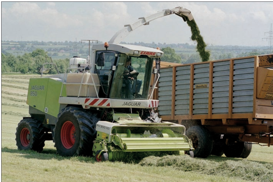
Flüssigdosierer für Siliermittel (hier direkt am Häcksler) versprechen eine sichere Dosierung und die beste Verteilung des jeweiligen Präparates. Foto: Thaysen
